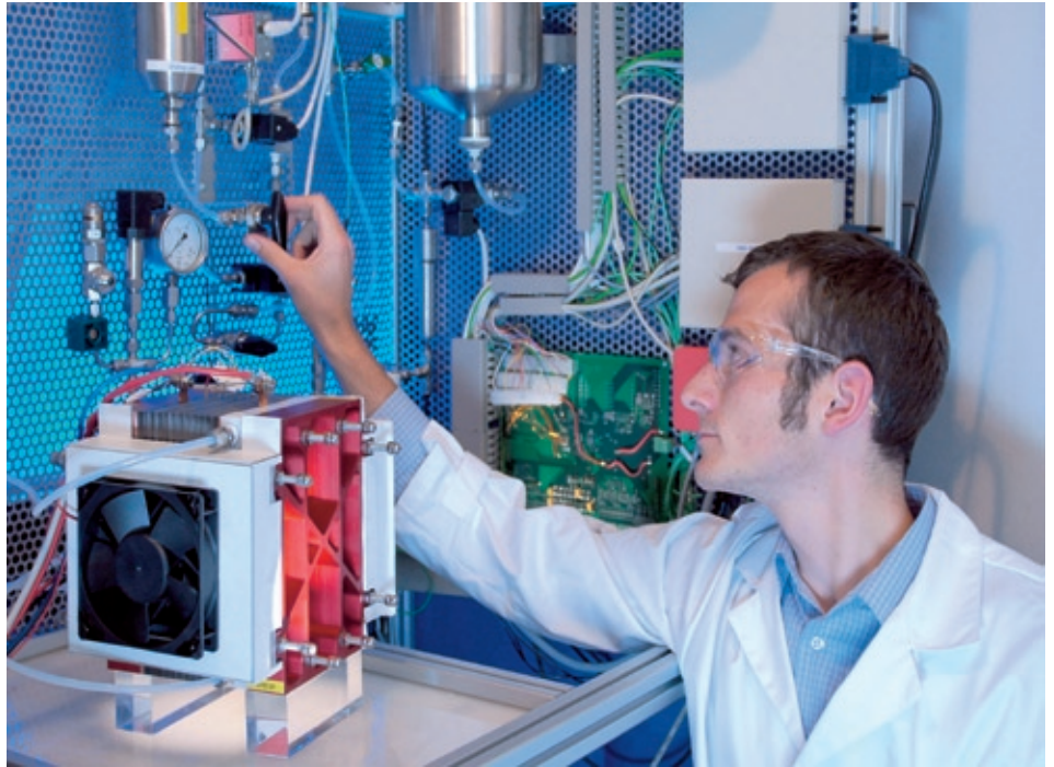
Test einer reversiblen Brennstoffzelle im Betrieb als Elektrolyseur.
