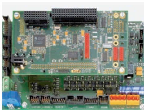
Regelungselektronik für ein komplett automatisiertes Elektrolysesystem.
