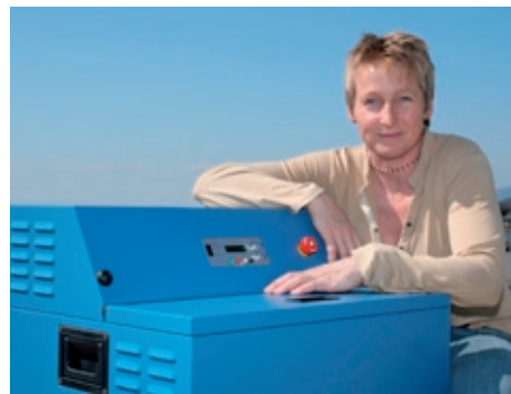
Portabler Druckelektrolyseur mit Trocknungseinheit zur Befüllung von Metallhydridspeichern.
