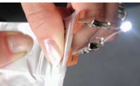
Flexible Folienbatterie. Fraunhofer ISIT.
