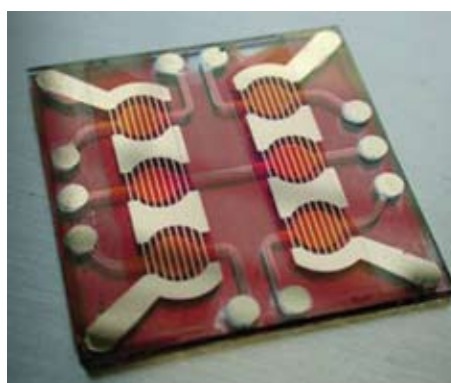
Organische Solarzelle. Fraunhofer ISE.
