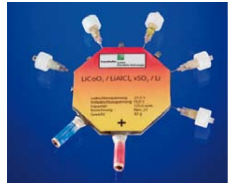
Tieftemperaturfähiger Hochleistungsakkumulator. Fraunhofer ICT.
