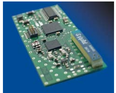
Transceiver zur Übertragung von Sensordaten. Fraunhofer TEG.
