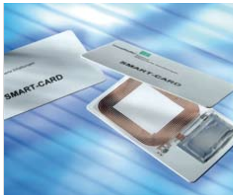
Smart Card mit induktiver Energieübertragung. Fraunhofer IIS.
