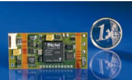
Universelles Modul für Batteriemangement und -monitoring. Fraunhofer IIS.
