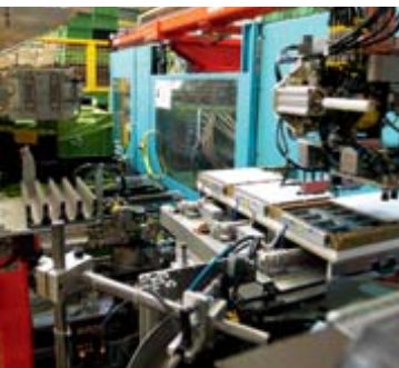
Automatisierte Zuführung und Vorwärmung zur Umspritzung von Bauteilen
